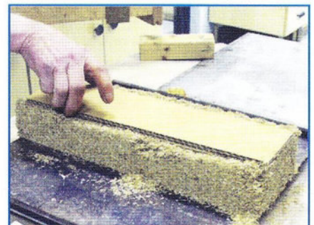
Elaboración de tablero con resina termoestable.
