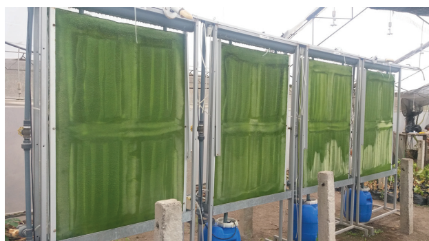
Figura 2. Producción de algas en botellones y paneles a nivel de invernadero.
