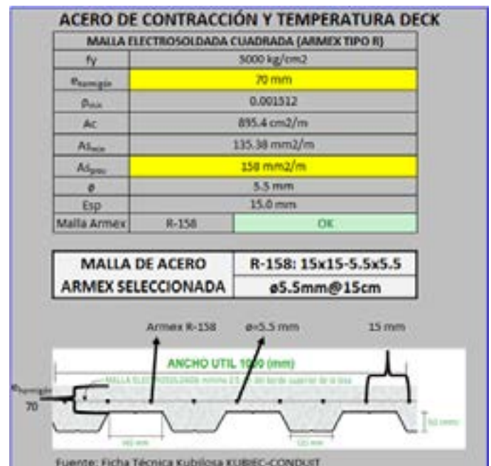
Figura 4. Diseño de la malla de acero electrosoldada
