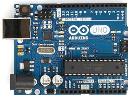
**Figura 4.** Placa Arduino UNO
