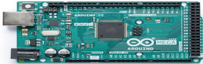
**Figura 6.** Placa Arduino MEGA
