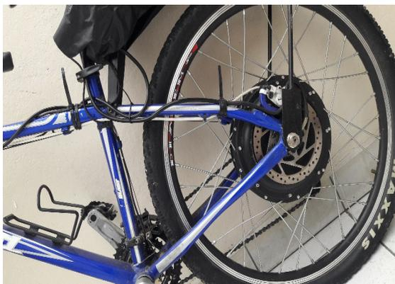
**Figura 2.** Ensamble de motor en rueda posterior
