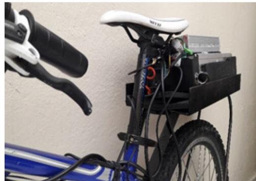
**Figura 3.** Ensamble controlador y batería
