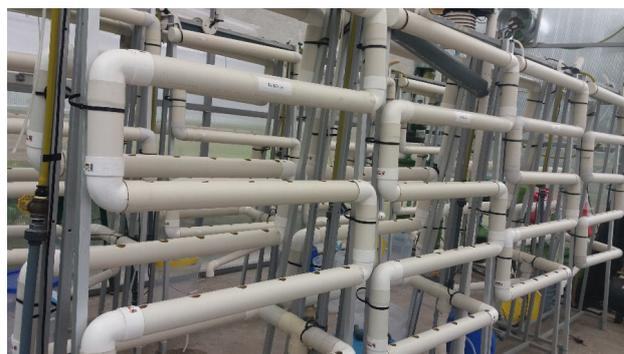
**Figura 4.** Instalación del sistema hidropónico.
